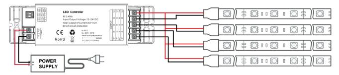
Application Circuit 2: CW+WW( V+→COMMON、CH1→CW、CH2→WW、CH3→CW, CH4: WW.)
